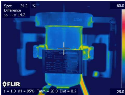
Fig. 19: Aufnahme einer IR-Kamera der Außenwand des Druckreaktors. Vorderansicht bei eingestellter Temperatur von 55°C.
